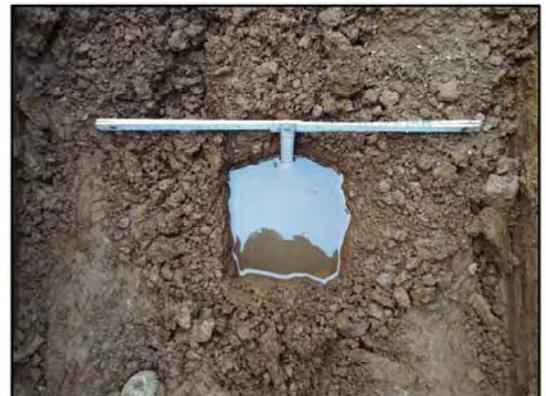
Foto 2: particolare della prova di permeabilità TA (1.00 m da p.c.).
